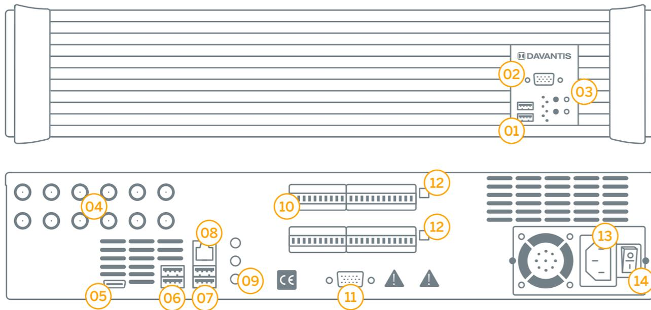
01 - 2 ports USB 2.0 02 - 1 port VGA 03 - 1 interrupteur marche/arrêt 04 - ports BNC (AV-KIT facultatif) 05 - 1 port HDMI 06 - 2 ports USB 3.0 07 - 2 ports USB 2.0 08 - 1 prise réseau RJ45 10/100/1000 09 - 1 prise stéréo analogique 10 - 8 entrées NO ou NF 11 - 1 prise VGA 12 - 4/8/12/16 sorties de relais internes NF (facultatives) 13 - 1 logement de câble d'alimentation 14 - 1 interrupteur d'alimentation
